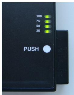
Abbildung 4-7. Der Knopf für die integrierte Prüffunktion und die Leuchtdioden an der Batterie (UA1225).
