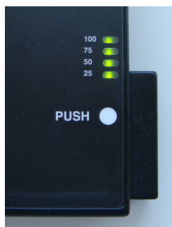
图 4-7. 电池上的内置检查按钮和二极管 (UA1225)。
