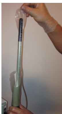
Рисунок 9. Надевание внутреннего чехла.
