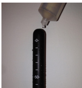
Рисунок 8. Смачивание датчика водой.
