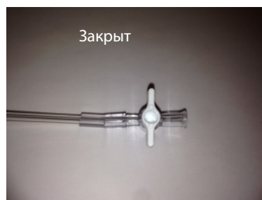
Рисунок 14. Запорный кран в открытом и закрытом положении.
