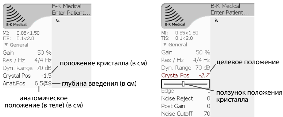
Рисунок 5. Положение кристалла в датчике 2052.
