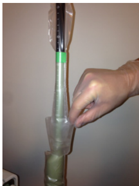
Рисунок 15. Снятие наружного чехла.
