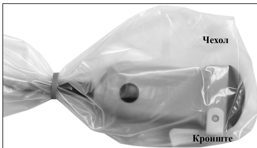
Рис. 6. 8823 с многоразовым кронштейном и защитной оболочкой датчика.
